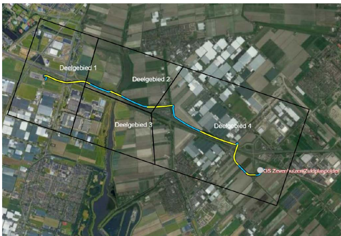
Afbeelding 2.4: Weergave voorkeursvariant, blauw is open ontgraving en geel is horizontaal gestuurde boring
