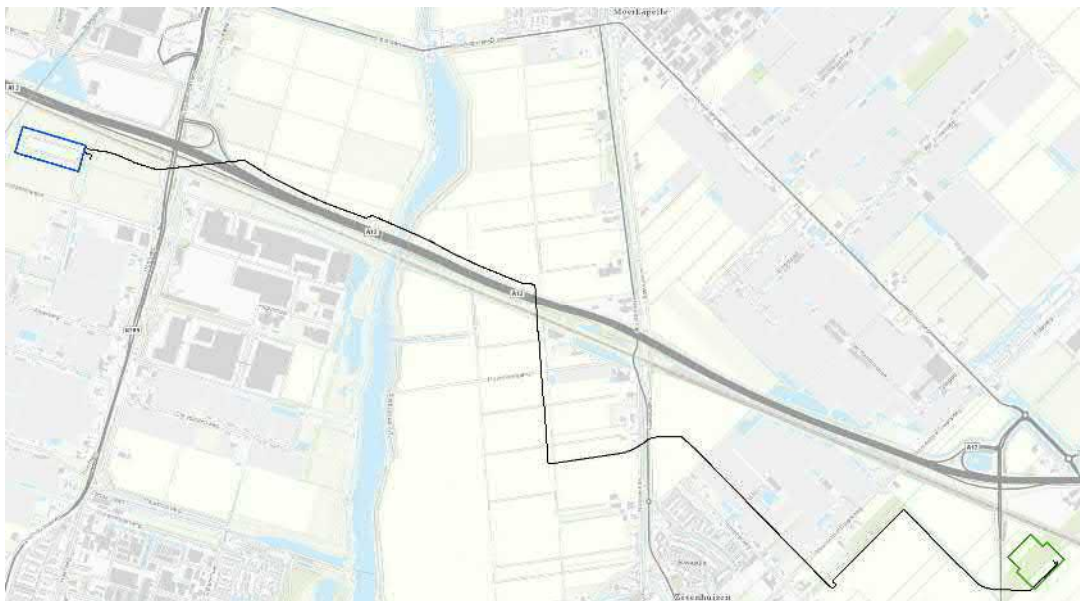
Figuur 1.1 Uitbreiding hoogspanningsnet Zuidplaspolder met het huidige transformatorstation (blauw), de 150kV kabelverbinding (zwart) en het nieuwe transformatorstation (groen).
